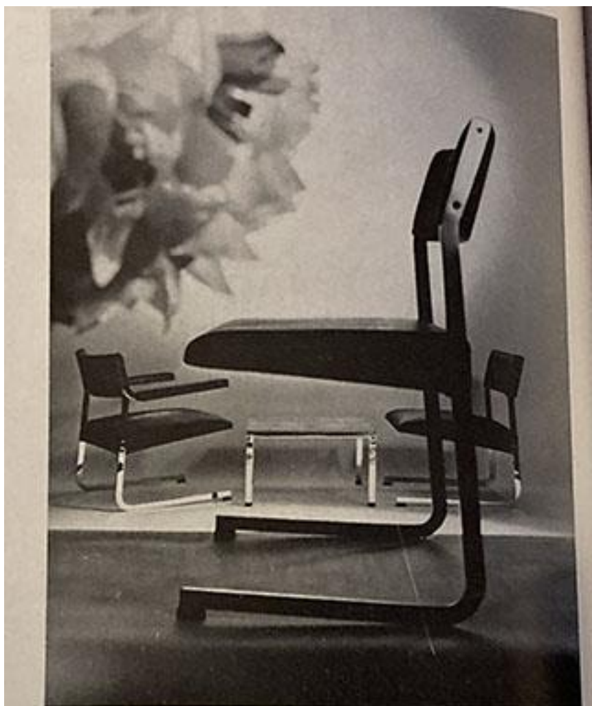
2. — Sièges de la série Rigel, créés par J.-A. Motte (Editeur Steiner). Le châssis se compose de deux équerres en acier plat chromé ; elles constituent en même temps les pieds, en forme de patins, dossier et siège y sont accrochés. Garniture vinyl expansé, cuir ou tissu. La série comprend des chaises et des fauteuils bas, avec ou sans accotoirs. Recouvrement en cuir, tissu ou tissu enduit. Assortie aux sièges de cette série, une table basse, carrée, en marbre, piétement acier chromé.
